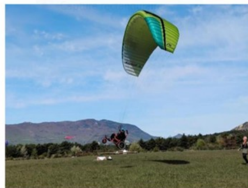
L'utilisation d'un treuil électrique permet de décoller.
