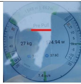
16. Quand le pilote va gonfler dos ou face, une détection de mouvement va être reconnu pour le treuil et au bout de 6 secondes commencera le procès de traction
